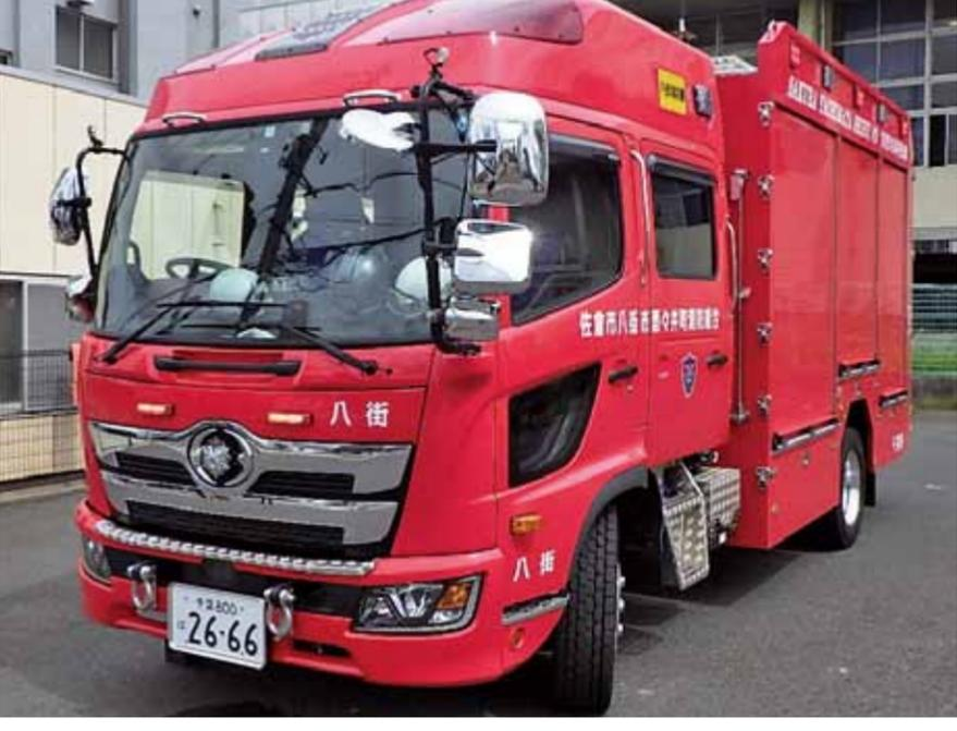
八街消防署に新型水槽付消防ポンプ自動車配備されました。この車両は、最新の機器を備え、火災現場でより早く放水が行えます。また、以前の車両と比べ、キャビンがハイルーフ化(高さ1.8m)されており、隊員が車内で空気呼吸器などの装備を容易に着装することが可能で、現場到着後も素早く活動を開始することができます。
