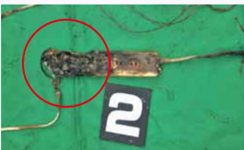
焼損したテーブルトップ
