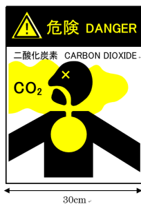
【防護区画の出入口に設ける二酸化炭素の危険性等に係る標識（「二酸化炭素消火設備の設置に係るガイドライン」より）】
